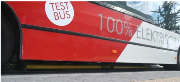
BU: Automatisches Absenken der Abnehmerspulen zur Primärspule im Asphalt (Conductix-Wampfler)
