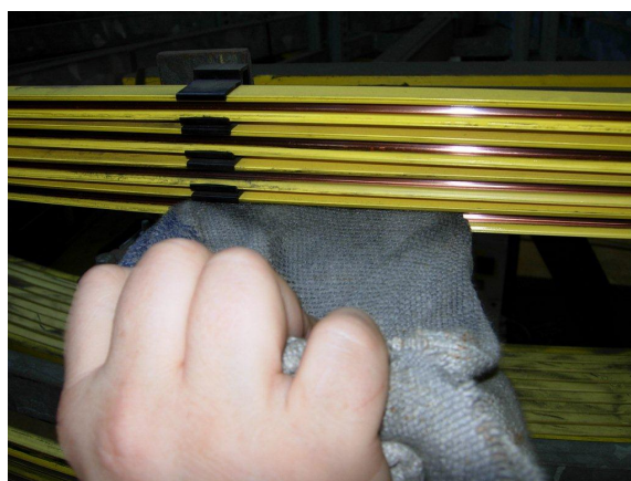
Obrázek 9: Rovněž odstraňte nečistoty ze závěsných svorek
